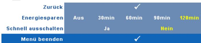
**ENERGIESPAREN**—Zum Deaktivieren des Energiesparmodus wählen Sie **Aus**. Per Vorgabe wechselt der Projektor in den Energiesparmodus, wenn innerhalb von 120 Minuten keine Aktivität erkannt wird. 60 Sekunden, bevor der Projektor in den Energiesparmodus wechselt, erscheint eine Warnmeldung mit einem Countdown. Während der Countdown läuft, können Sie den Wechsel in den Energiesparmodus durch Betätigen einer beliebigen Taste verhindern.
