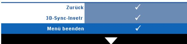
**3D-Sync-Invert**—Falls ein ungleichmäßiges oder überlappendes Bild beim Tragen der DLP-3D-Brille angezeigt wird, müssen Sie möglicherweise zur Erzielung einer optimalen Abstimmung der Links-Rechts-Bildfolge und damit der Gewährleistung einer korrekten Bildanzeige die „Invert“-Funktion ausführen. (bei DLP-3D-Brillen)
