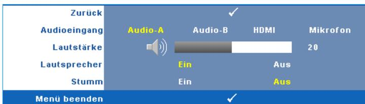
**AUDIOEINGANG**—Hier wählen Sie die Audio-Eingangsquelle aus; mögliche Optionen: Audio-A, Audio-B, HDMI und Mikrofon.
