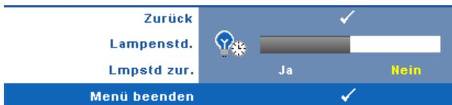
**LAMPENSTD.**—Hier werden die Betriebsstunden seit dem Zurücksetzen des Lampen-Timers angezeigt.
