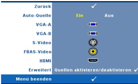
**AUTO-QUELLE**—Wählen Sie Aus (Standardauswahl), um das aktuelle Eingangssignal zu speichern. Wenn Sie die **Quelle**-Taste betätigen, während **Auto-Quelle** auf Aus eingestellt ist, können Sie das Eingangssignal manuell auswählen. Wählen Sie **Ein** zur automatischen Erkennung verfügbarer Eingangssignale. Wenn Sie bei eingeschaltetem Projektor die
